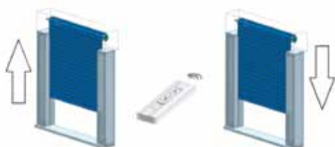
Semplice inversione del senso di movimento dal radiocomando Easy inversion of the sense of rotation by the remote
